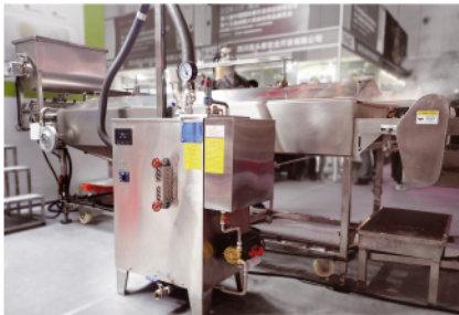
Steam Generator 蒸汽发生器
